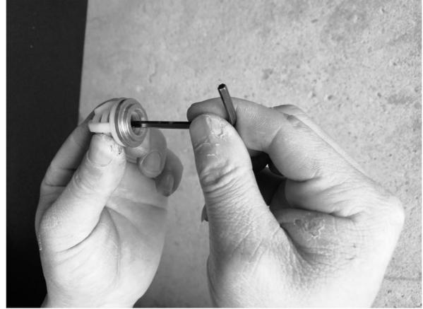
2.取出6只单向阀，检查每个单向阀有无损坏，单向阀处弹簧和阀门有无异物或者阀门粘合，用针型物用力捅开已粘合的弹簧口阀门，单向阀处弹簧和阀门有异物须及时清理干净。
