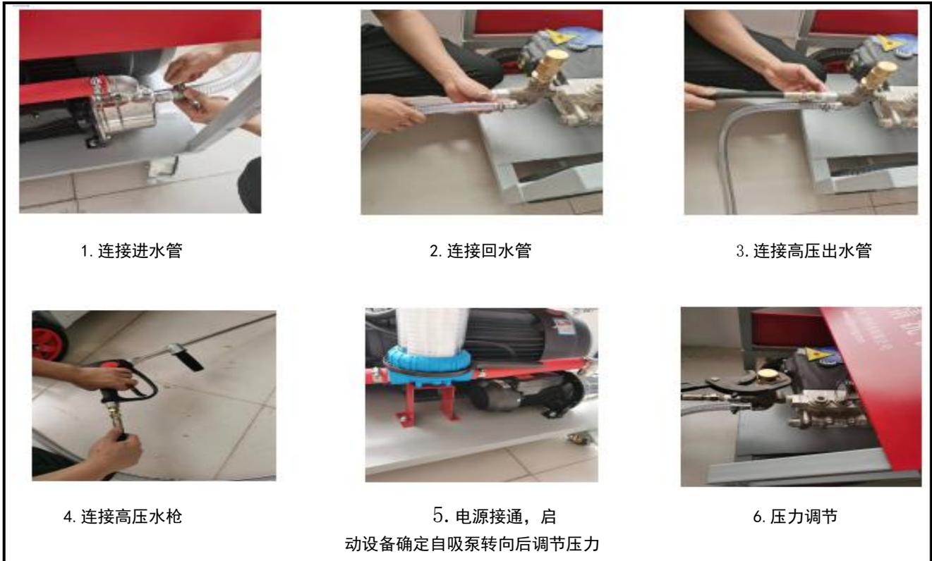
1、本机器是 380V 三项电水高压清洗机（注：使用前，连接外接水源，电源接通后启动确认自吸泵转向，转向错误请重新连接电线调整相序）。
