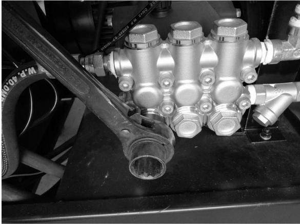
1.用扳手拧开高压泵铜块6个六角大螺帽，取出6只单向阀
